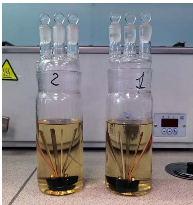
При испытаниях на коррозию проверяли две пробы параллельно, чтобы исключить случайности.
