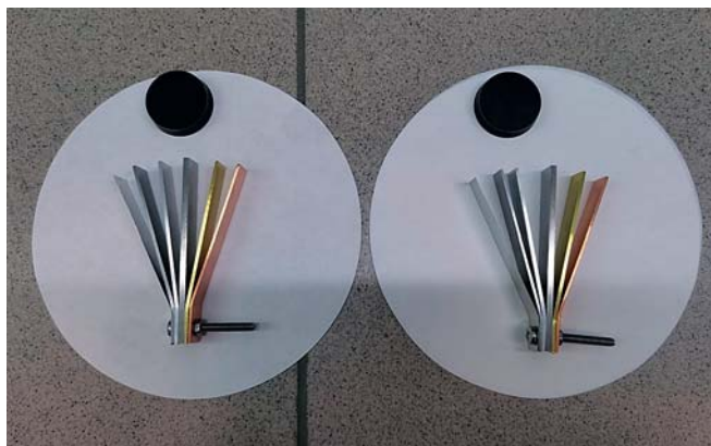
При испытаниях на коррозию проверяли две пробы параллельно, чтобы исключить случайности.
