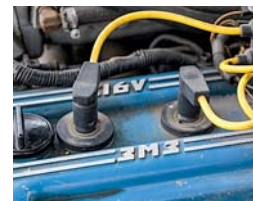
Под капотом – 16-клапанный мотор 3MZ-405 мощностью 155 л. с.
